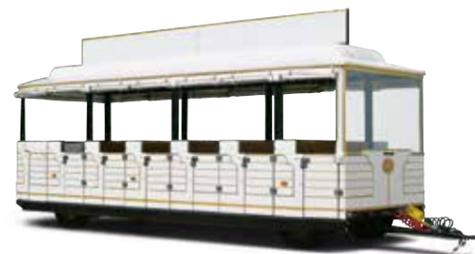
Equipada con puertas que se abren por un lado y puertas fijas en el otro, dispositivo de minusválido y luz giratoria.
