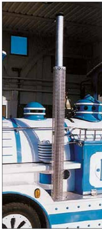
Conducto de descarga de acero inoxidable externo hacia arriba
