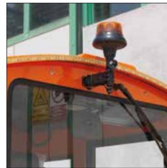
Sistema de luces en el borde del techo de la locomotora e luz giratoria
